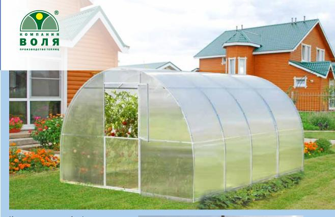
Каркас теплицы «Альфа» сделан из оцинкованной трубы. Дуги теплицы из поликарбоната «Альфа» заканчиваются специальными колышками (30см.) с Т-образным окончанием. Так, если у вас ровный участок без укосов и ям, вы можете сэкономить на фундаменте и установить теплицу в грунт. Снеговая нагрузка на теплицу «Альфа» - 30кг/м2. Покупатель может увеличить прочность теплицы докупив комплект усиления уменьшив расстояние между дугами до 68см и до 51см и поставив телескопические опоры на зимний период.
